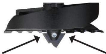
**IMPORTANT - La lame à pointe centrale lors de la réinstallation doit être centrée entre les deux lames principales du broyeur. La pointe unique à deux étages peut ressembler à une pointe cassée, mais elle est conçue de cette façon.**
